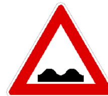
A 7a Nerovnost vozovky
